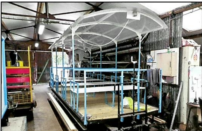
St Trojan – Dépôt-Atelier du Prévent, baladeuse en reconstruction pour la rame supplémentaire. Tous clichés B. Vieu (28/08/24)
