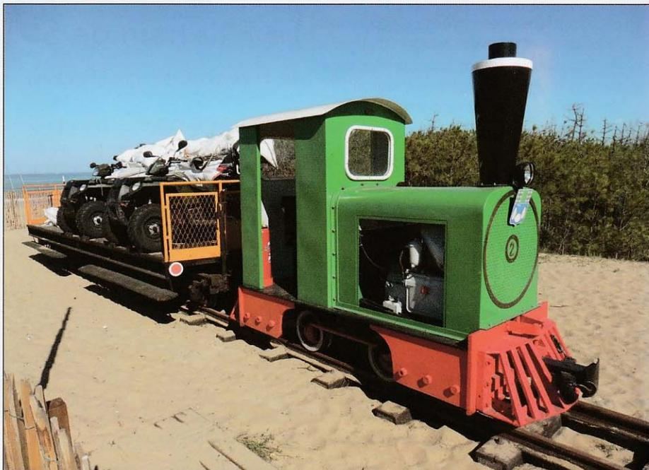
**St-Trojan - Le locotracteur Deutz n° 2 qui tracte matin et soir le wagon (ex-baladeuse n° 7) porte quads (école de voile) et le wagon-bar.**
